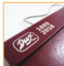
Тиснение на обложке металлизированной фольгой
