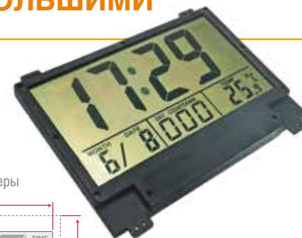
Внешний вид модуля больших электронных часов
